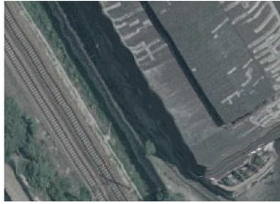
Figura 5 - Effetto ondulato al bordo degli edifici causato dall'utilizzo di un DSM.
