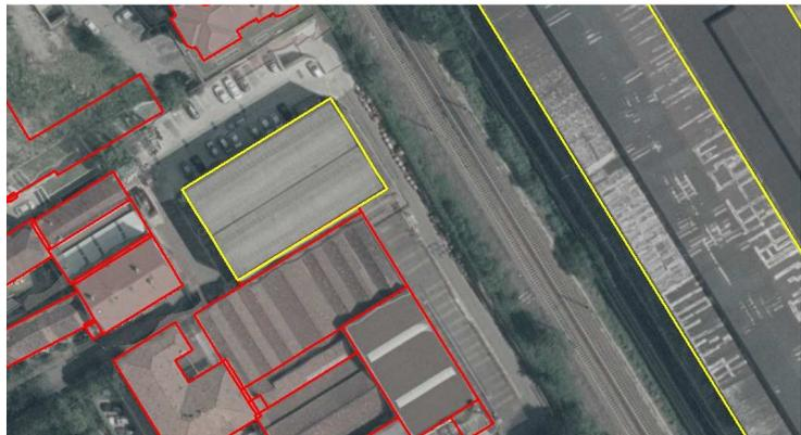
Figura 6 - True-ortofoto dell'area considerata ottenuta con il metodo sviluppato.
